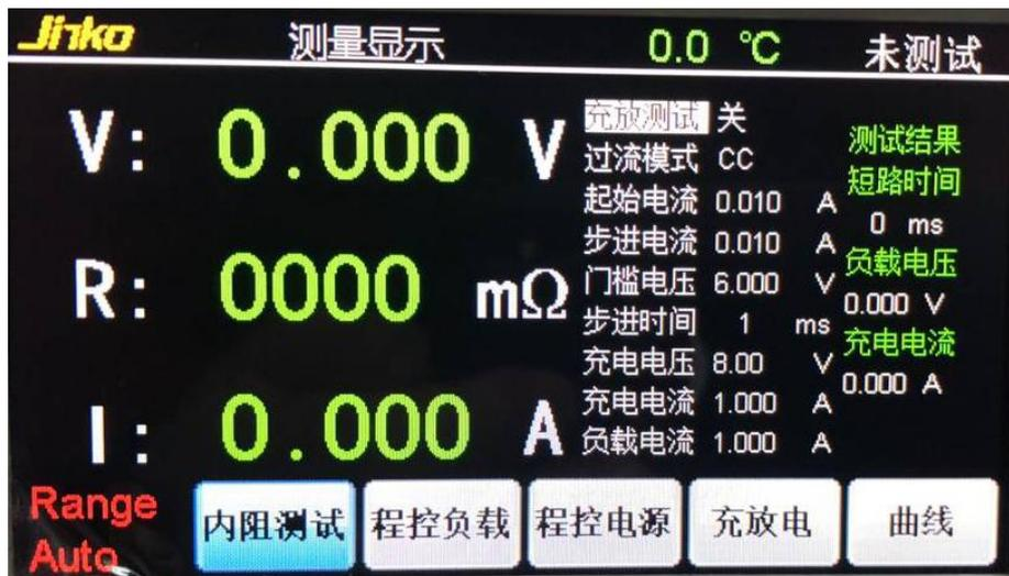
1.内阻测试界面左下角显示的是当前内阻测试的档位状态，若显示为 AUTO，则档位自动切换；若显示为 250mΩ，则说明当前测量的内阻范围为 0-250mΩ。若显示为 2000mΩ，则说明当前测量的内阻范围为 0-2000mΩ。三种状态通过档位键切换点来设置（此功能仅 JK5530B 有）
