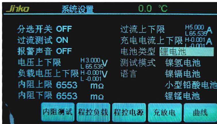
电池测试状态显示，以选择电池类型锂电池为例
