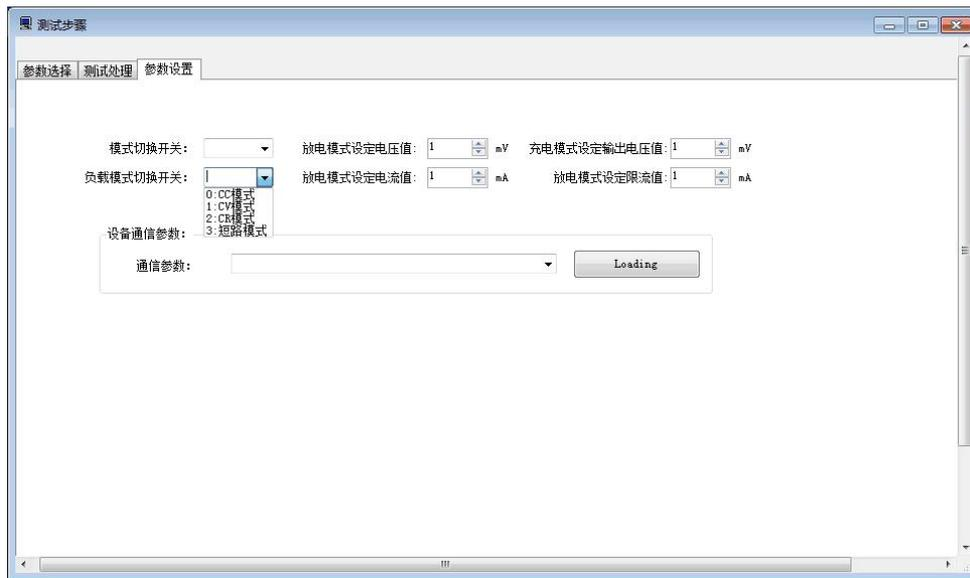
用户需在此界面选择过流测试的负载模式后开始测试（仅支持 CC,CV 模式）
