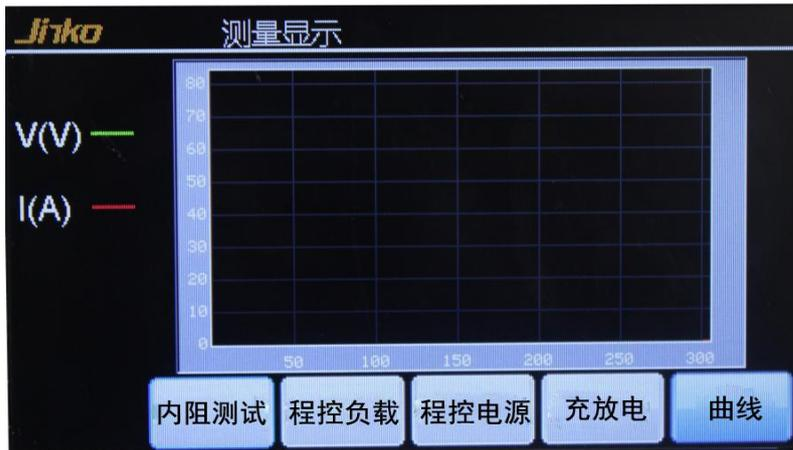
曲线显示界面，显示电压和电流的值
