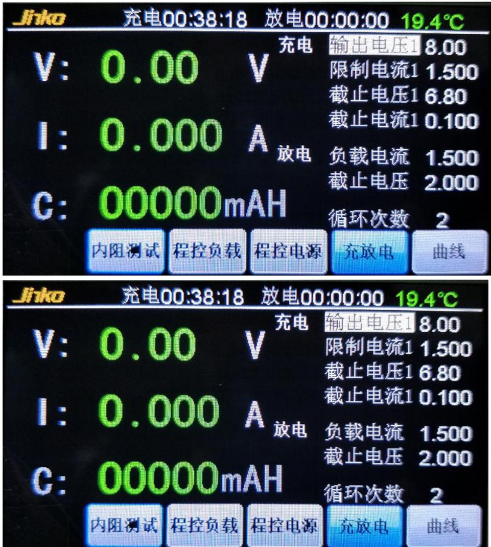
如果需要分步充电，建议用户第一步用大电流，第二步用小电流，第三步用涓流。
