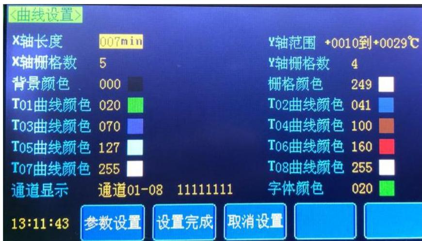
X轴长度：X轴时间值，1min~999min可自由设置。
